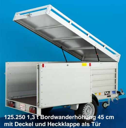
125.250 1,3 t Bordwanderhöhe 45 cm mit Deckel und Heckklappe als Tür
